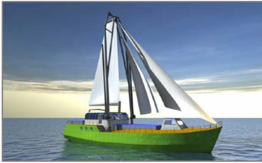
Greenheart 船舶的透视图该船只配备了 Upsolar 电池组件
